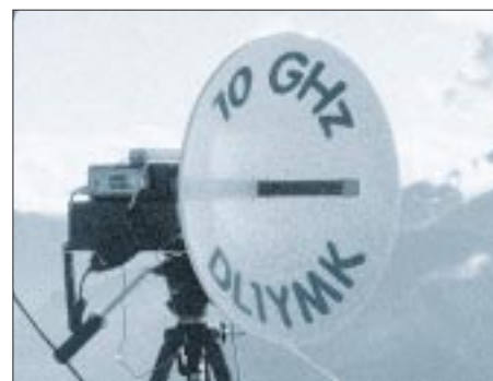
Parabolspiegel mit 48 cm Durchmesser – eine sinnvolle Wahl für den Einstieg. Foto: DG0ZB
