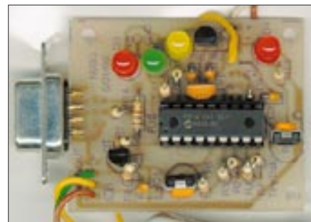
Bild 4: Tiny-Trak, als Bausatz erhältlich, sendet ohne TNC&Co. APRS-Pakete.
