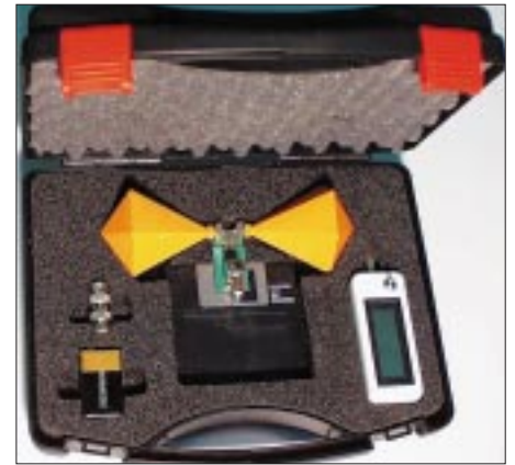
Bild 7: Meßkoffer II mit Breitbanddipol BMA1, Pegel- meßgerät PWRM2, BNC-BNC-Adapter, 9-V-Batterieblock und Diskette mit Daten
