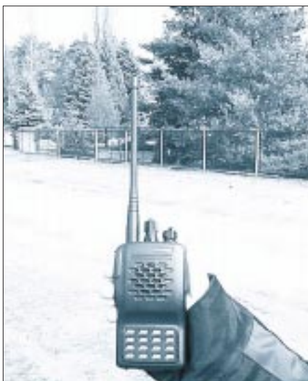
Bild 2: Das VX-246 macht einen soliden Eindruck, liegt gut in der Hand und leistet die für PMR-Geräte üblichen 500 mW HF.
