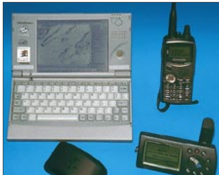
Bild 3: Mögliche Konfiguration für eine APRS-Anwendung mit Plamtop, GPS-Handy und dem Duoband-Handy TH-D7E nebst integriertem TNC. Fotos: DK2WV (2)
