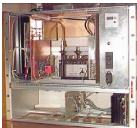
Das gesamte 70-m-Relais DB0AUB (Berlin-Wedding) in seinem Rack. Unten darin die ungehorsame Controller-Platine
