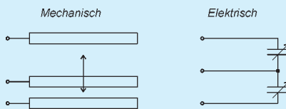
Bild 5: In der G-Zelle befindet sich zwischen zwei feststehenden eine bewegliche Platte.
