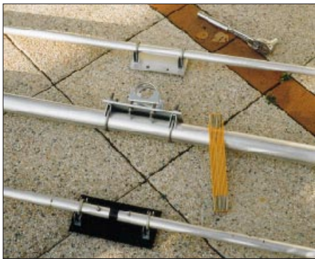
Bild 2: Mittelteile von Direktor, Boom und Strahler
