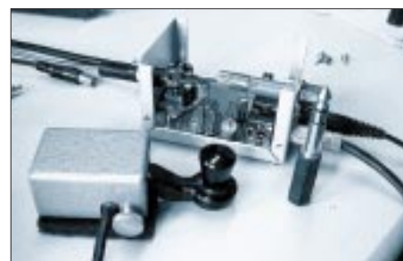
Bild 19: Ein Mini-Direktmisch-Transceiver aus dem QRP-Report 1/2001 Foto: DL2FI
