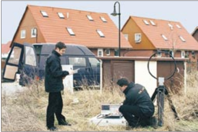
Störfeldstärke-Messungen beim Oneline-PLC-Versuchsprojekt in Barleben mit Rahmenantenne HFH2-Z2 und EMI-Testreceiver ESCS30 von Rohde & Schwarz
