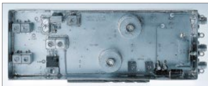
Der als Fertigmodul sowie im Bausatz lieferbare DB6NT-Transverter hat ein Rauschmaß von 1,2 dB und gibt eine Sendeleistung von 200 mW ab – bei Abmessungen von 150 × 60 × 30 mm 3 .
