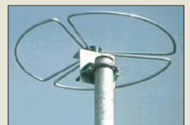
Großes Rad ganz klein: horizontal polarisierter Rundstrahler für 70 cm
