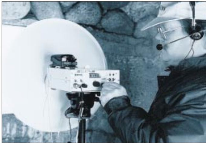
Steen, OZ9ZI, beim Portabelbetrieb im Leuchtfeuerhaus von Verdens Ende in Richtung Skagen; das Gerät am Spiegel ist ein kompletter 10-GHz-Transceiver Solectra mit 200 mW Output – Eigenbauprodukt dänischer Funkamateure.
