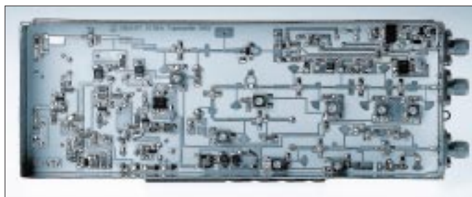
Die Unterseite läßt erkennen, daß die SMD-Bestückung eine recht filigrane Angelegenheit ist – die Bausatzvariante ist demnach nicht als SMD-Erstlingswerk zu empfehlen... Werkfotos: DB6NT
