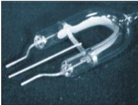
Bild 3: Für unser Stroboskop eignen sich die handelsüblichen kleinen Blitzröhren.
